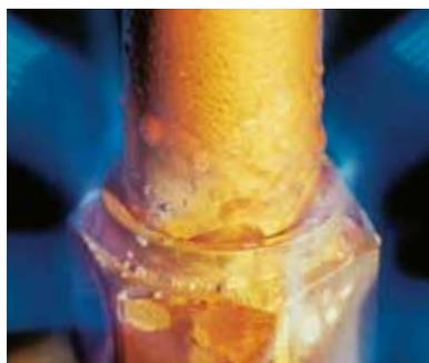
Kurz vor Erreichen der Löttemperatur wird das Flussmittel durchsichtig und fliesst wie Wasser über die Lötstelle.
