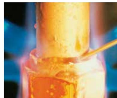
Das Flussmittel schützt das Werkstück während des Lötprozesses.
